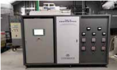
镍离子废水深度处理示范平台
