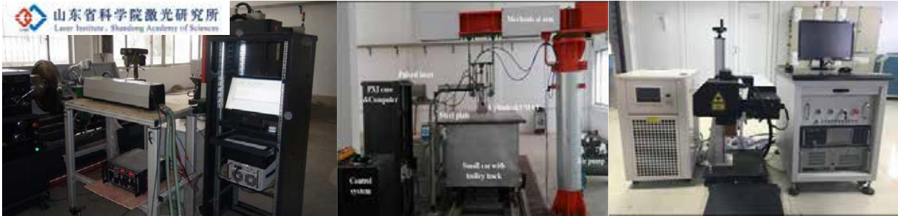
自主研发的激光-电磁超声检测系统
