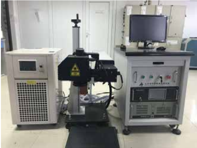
自主研发的全自动激光超声扫描成像系统
