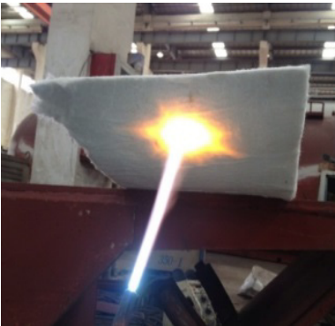
图 2、气凝胶纤维毡耐烧蚀实验（1200℃）
