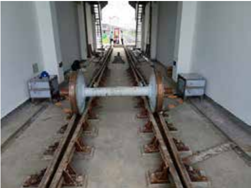
列车轮对电磁超声在线检测系统
