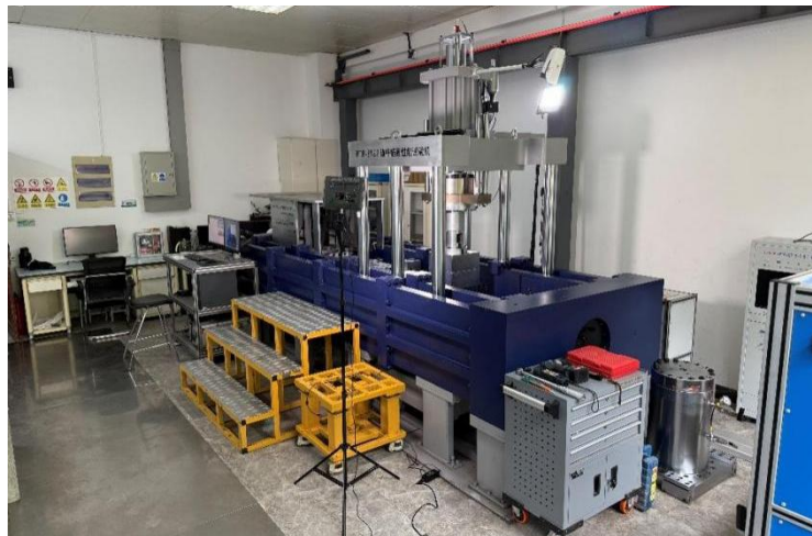
图 3 锚杆锚固性能拉剪扭试验系统实物
