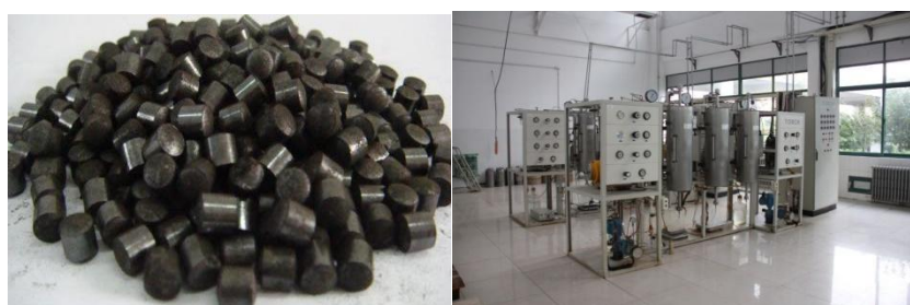
图 1 甲醇水蒸气重整制氢催化剂 图 2 中试装置
