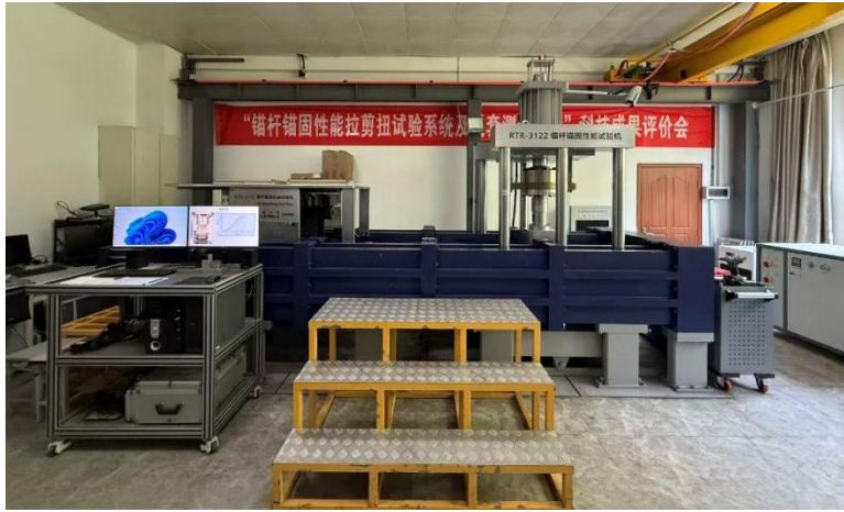
图 2 锚杆锚固性能拉剪扭试验系统实物
