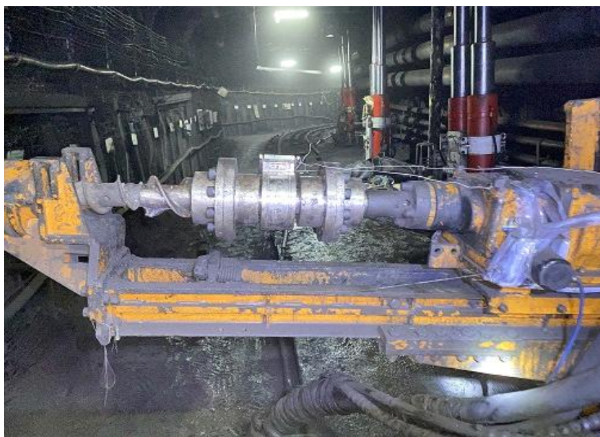
图 2 现场钻机钻进参数监测装备
